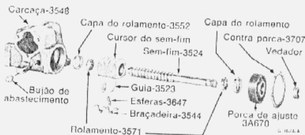
fig. 6 — componentes do sem-fim e peças correlatas
